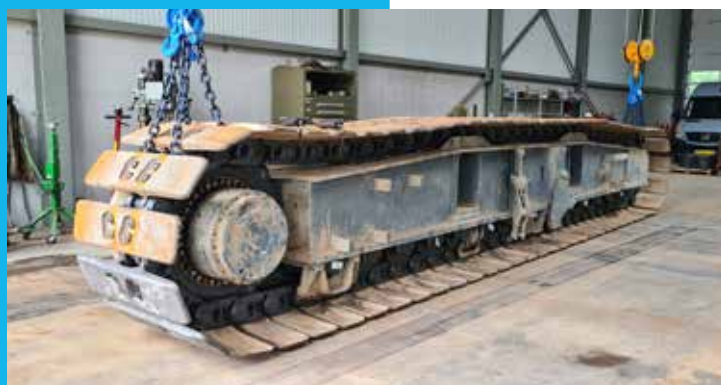
Revisie dragline rijwerk ► Dragline undercarriage overhaul
